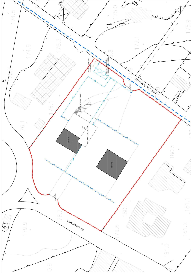
SCHEMA DI IMPIANTO DI PRIMA PIOGGIA CON SCARICO SU PUBBLICA FOGNATURA
